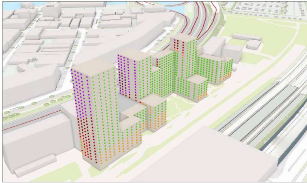
Legenda ● ≤ 48 dB (voorkeursgrenswaarde Wgh) ● 58-63 dB (boven grenswaarde Omgevingswet) ● 49-53 dB (maximale ontheffing Wgh) ● 64-68 dB ● 54-57 dB (boven maximale ontheffingswaarde Wgh) ● ≥ 69 dB Ooghoogte afbeelding: 200 meter 0 5 10 20 m mei 2020
