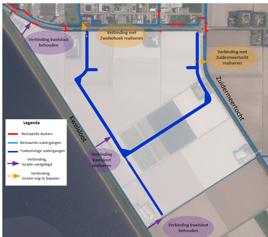
Afbeelding 5.5 Projectie ontwerp watergangen met aansluiting op bestaande watersysteem
