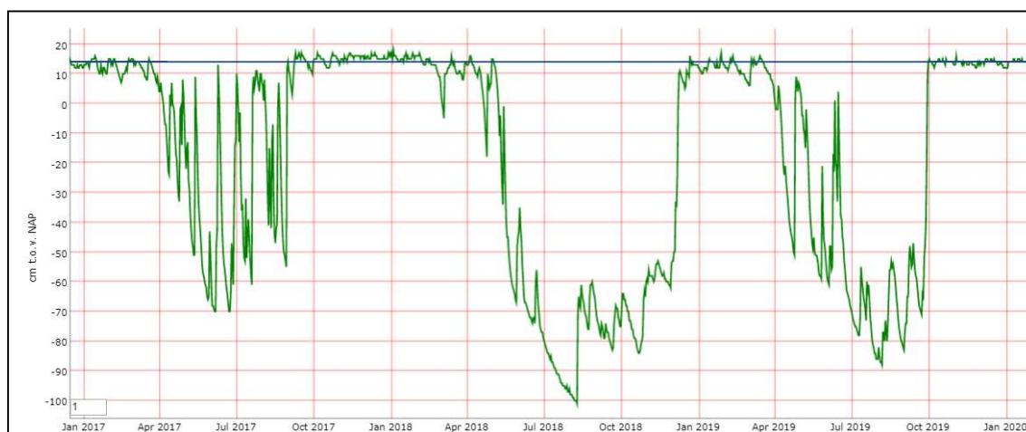
Figuur 4.3. Verloop stijghoogte diepere buis bij RU3 (cq. RU3b) voor de periode januari 2017 t/m december 2019 (groene lijn). De maaiveldhoogte is met een blauwe lijn weergegeven.
