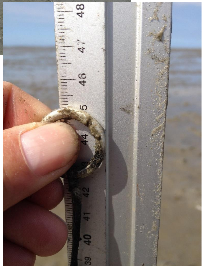
Figuur 5. Meetliniaal met meetvoet. Deze wordt steeds op dezelfde wijze op de bodem gezet waarna de lengte van het meettouw langs de schaal wordt afgelezen. In dit geval 45,1 cm.
