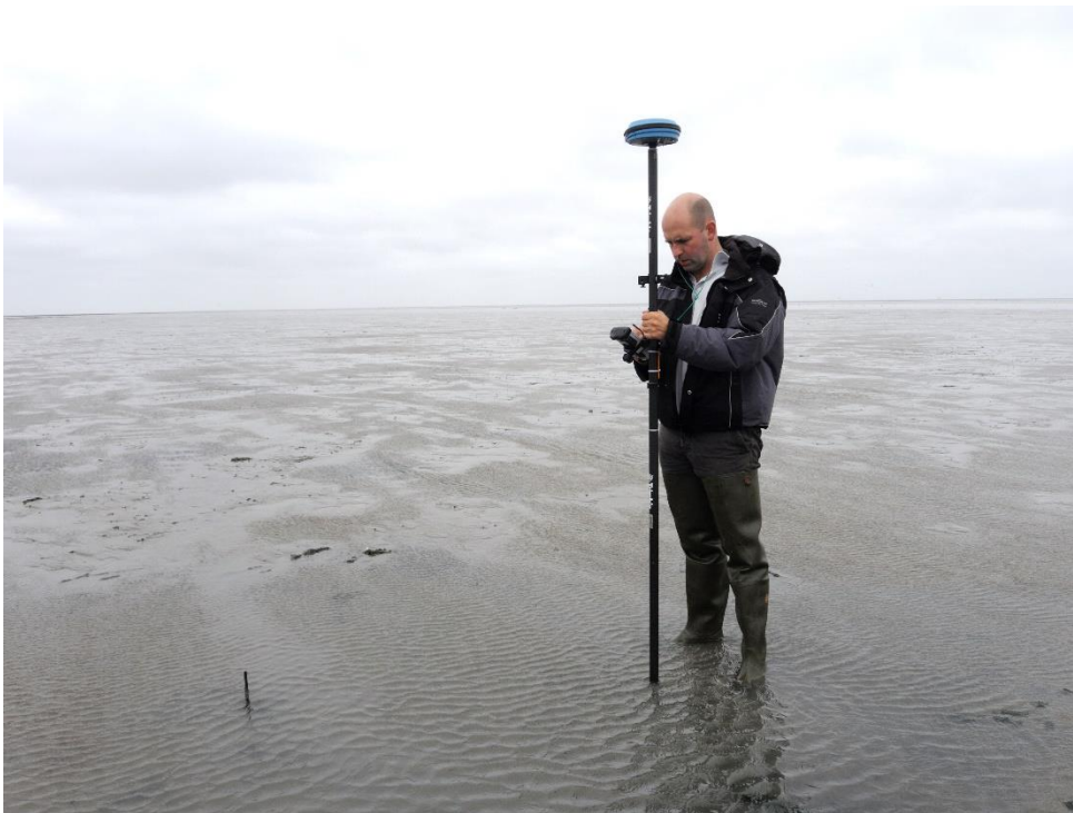
Figuur 27. Met DGPS inmeten van station P140 op het wad bij Paesens. Aan de onderkant van de staf is een rooster gemonteerd dat perfect op de wadbodem aansluit en niet wegzakt. De hoogte is ingemeten op de plaats waar het meettouw recht boven het grondanker uit de bodem komt. 2 september 2013. Foto J. Krol.
