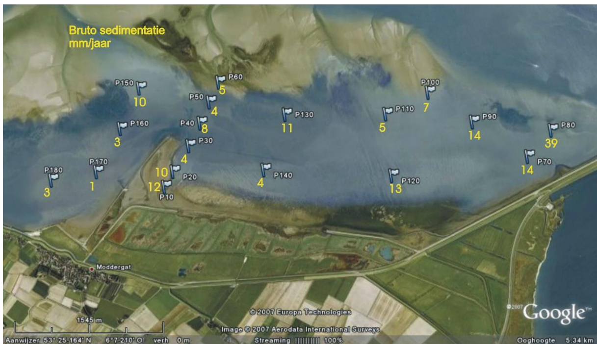
Figuur 26. Sedimentatiesnelheid per meetstation voor het onderzoeksgebied Paesens in de periode 2007-2019 in mm/jaar (gele cijfers). Data bijgewerkt tm 2019.
