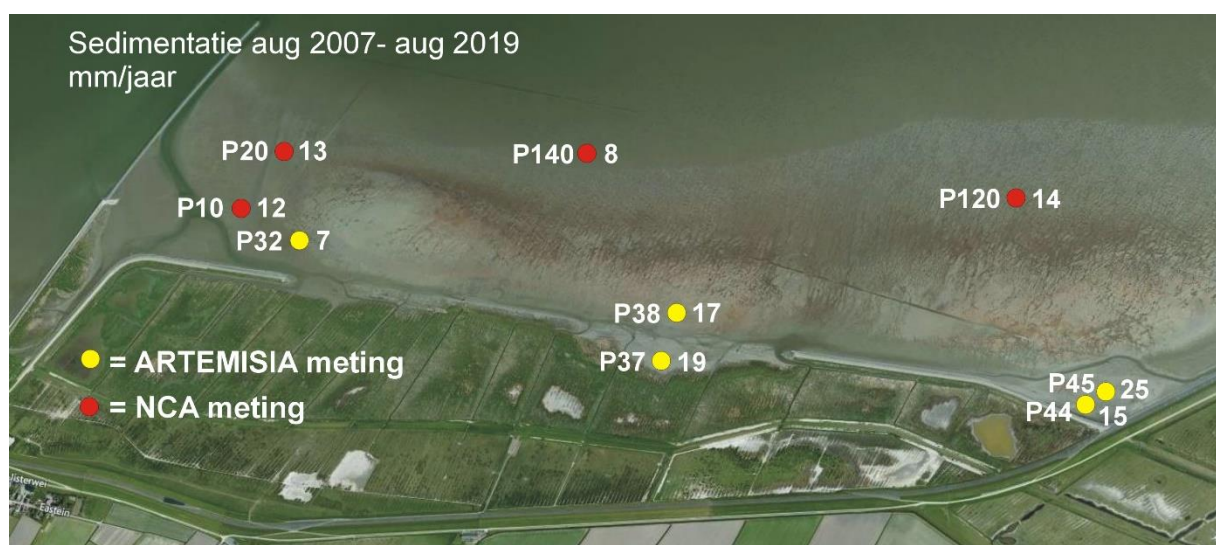
Figuur 36. Kaartbeeld met sedimentatie vergelijking van de meting van NCA en Artemisia. Over periode aug2007- aug2019. Rechts van de gekleurde stip waarmee de locatie van het meetstation wordt aangeduid staat de sedimentatie in mm/jaar.
