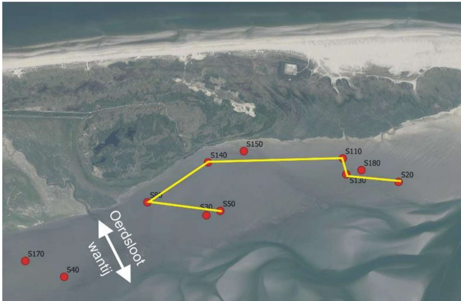
Figuur 14: Spijkermeting op het wad onder Oost-Ameland. Voor de met de gele lijn verbonden meetpunten geldt dat de bodemdalingsnelheid hoger is dan de sedimentatiesnelheid. Dit geldt dus niet voor de punten S30, S150 en S180 die vlak langs de gele lijn liggen. Dit is een deel van figuur 34 uit Krol (2020).
