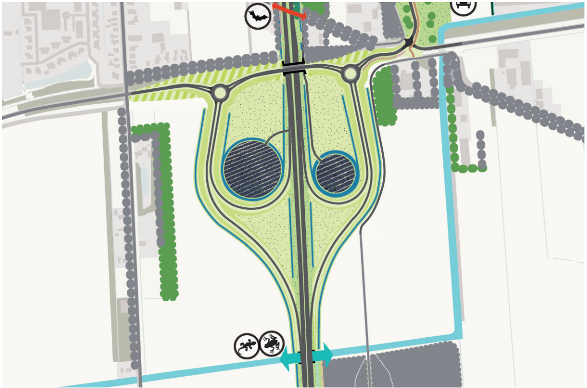
zonne -energie in oksels aansluiting Siddeburen
