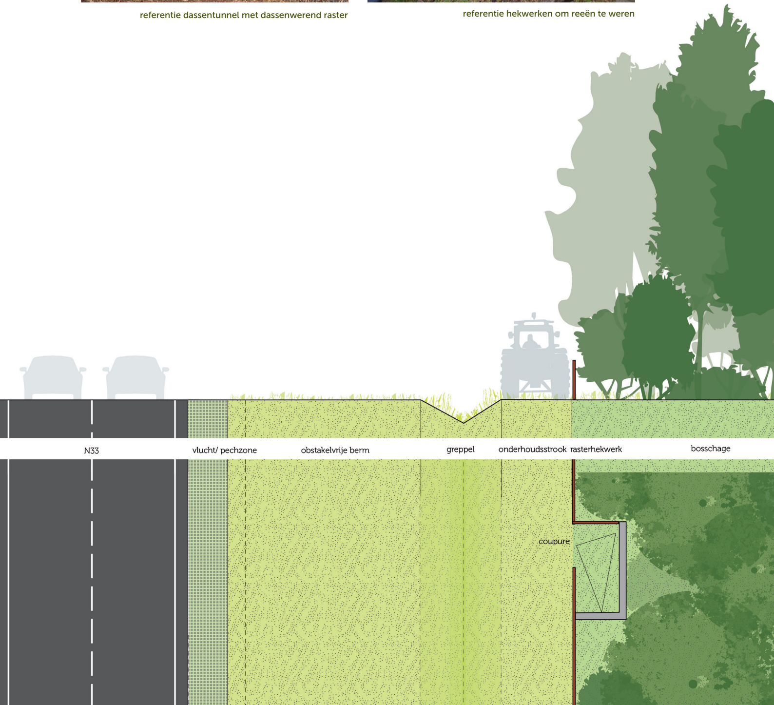
principe uitwerking (coupure) reeënhekwerk
