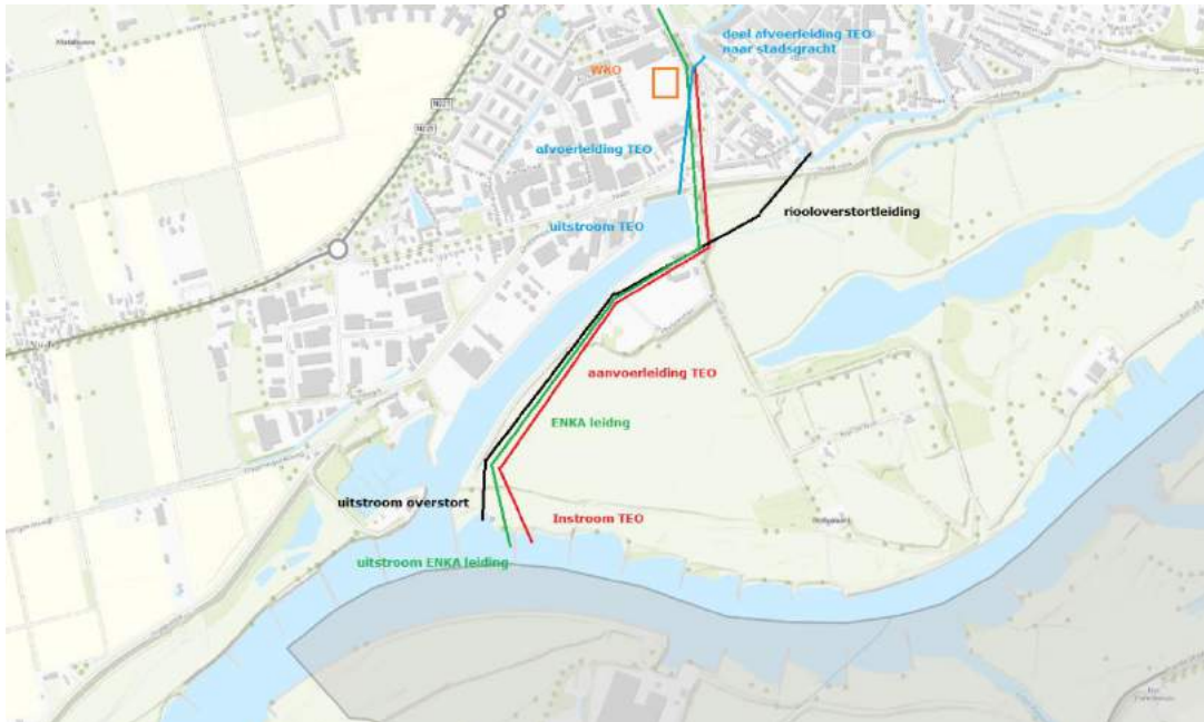
Figuur 0-1: Ligging overstort, ENKA-leiding en TEO aanvoer
