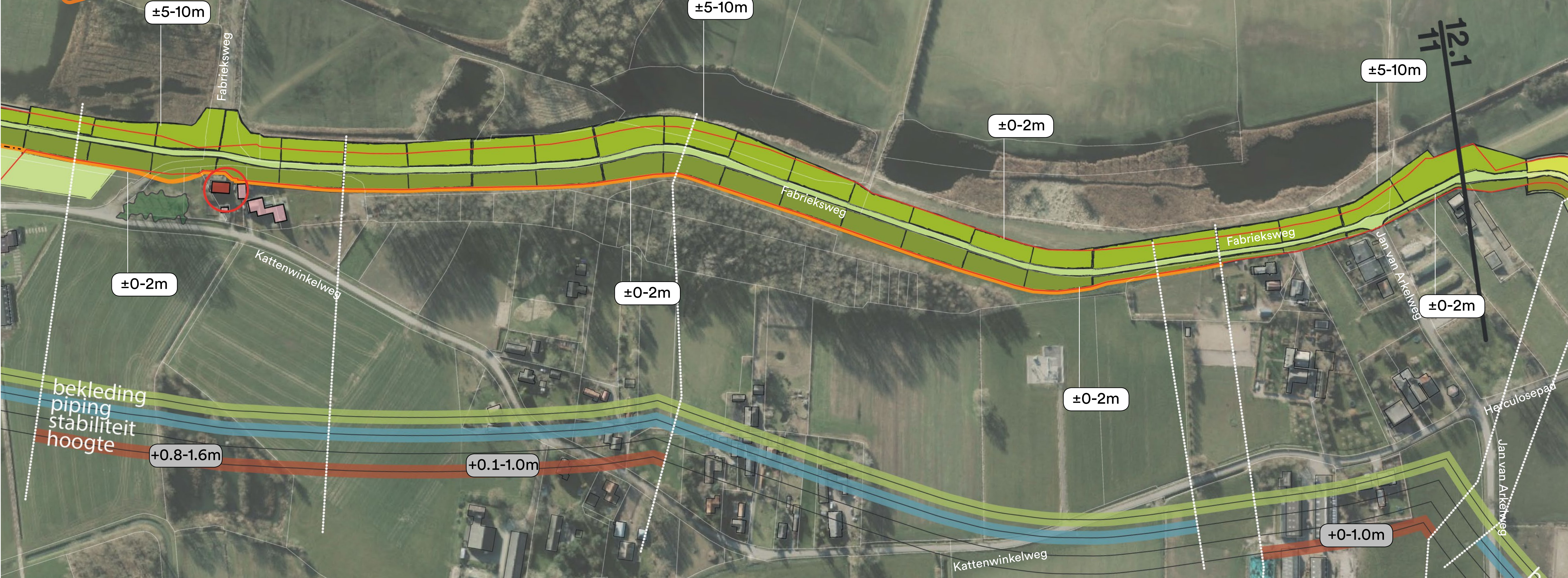
D VERSCHUIVING IN BUITENDIJKSE RICHTING MET BUITENDIJKSE KLEI-INGRAVING / VERTICALE PIPINGVOORZIENING
