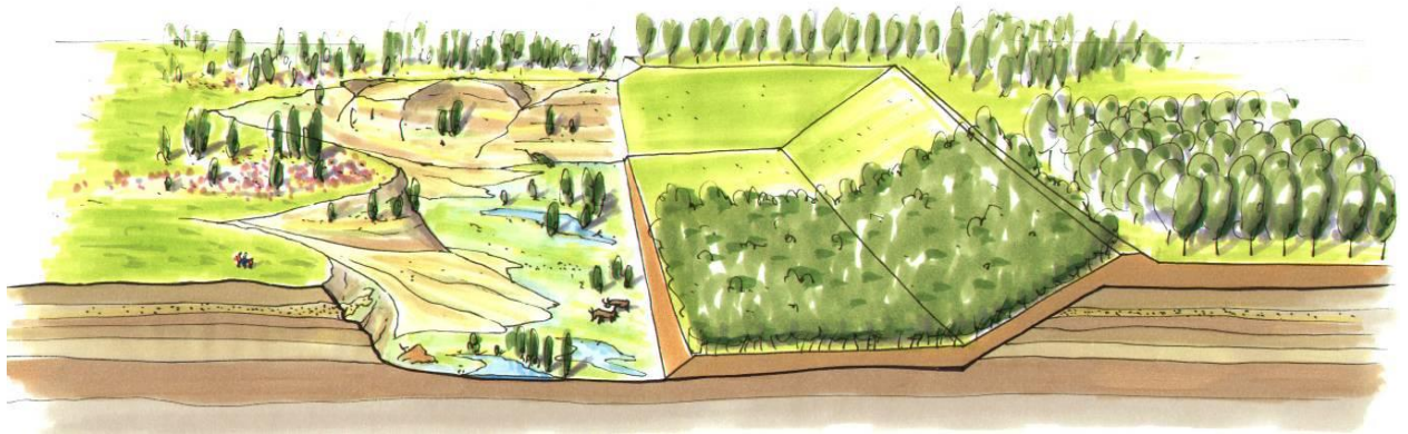
Figuur 2.4.2. Links een groeewand ingericht volgens de principes van Verborgene Valleien, rechts een groeve volgens de traditionele wijze heringericht.
