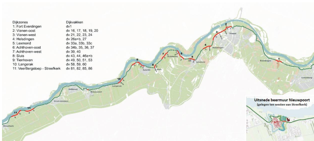
Figuur 1 Dijkzones Project SAFE en langconstructie Beermuur bij Nieuwpoort. In rood de delen van de dijk die nu versterkt worden.
