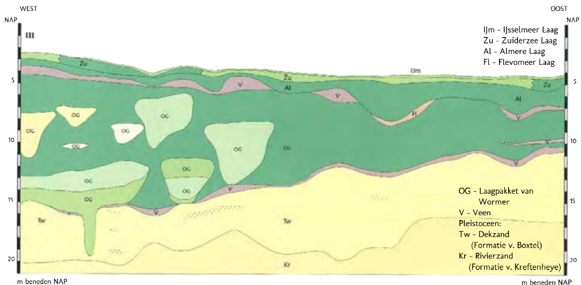
Afbeelding 7 Geologisch West-Oost profiel door het Markermeer (Lenselink/Menke 1995), waarin een vergelijkbare variatie in de ondergrond als in afbeelding 6 te zien is.
