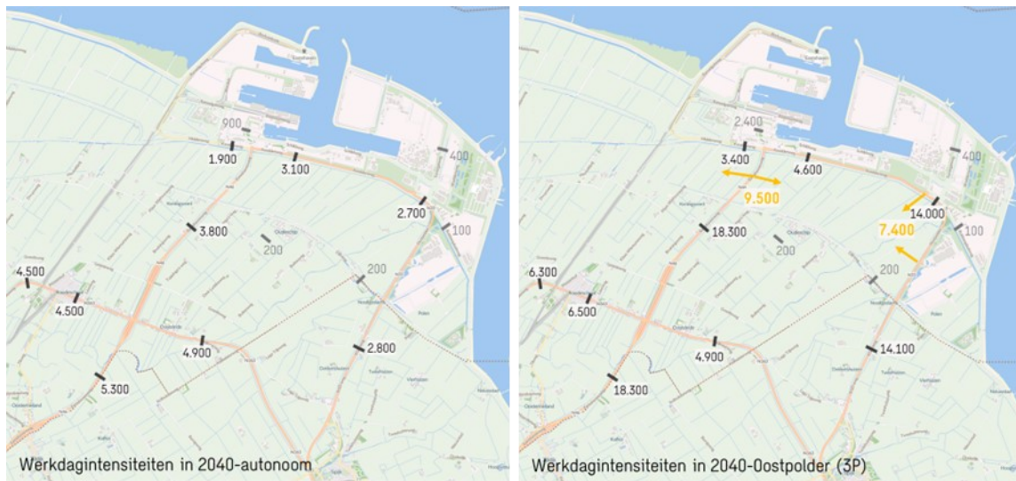
Afbeelding 19.1 Verkeersintensiteiten bij autonome situatie en de cumulatie van het planvoornemen Oostpolder en volledig Eemshaven (inclusief Eemshaven Zuidoost)
