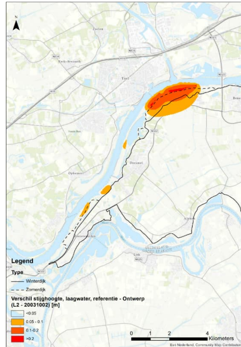
Afbeelding 11.14 Verskil stijghoogte bij laagwater t.o.v. referentiesituatie zonder maatregelen [75]
