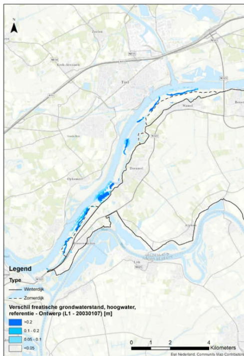
Afbeelding 11.1 Verschil freatische grondwaterstand bij hoogwater t.o.v. referentiesituatie zonder maatregelen [75]
