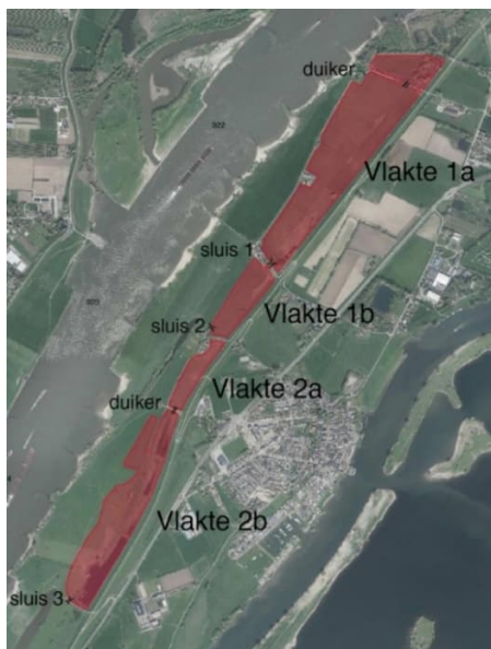
Afbeelding 11.20 Nieuw in te regelen overstromingsvlakten, vlakte 1a en 1b worden aangeduid met 'Voorn' en vlakte 2a en 2b met 'Heerewaarden'.
