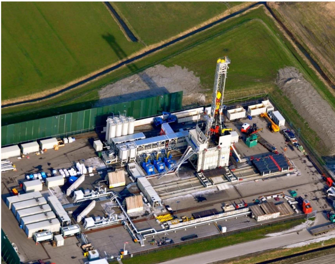
Figuur 2 Boorinstallatie inclusief boortoren en geluidswanden (bron: MER Boring en gaswinning Ternaard)
