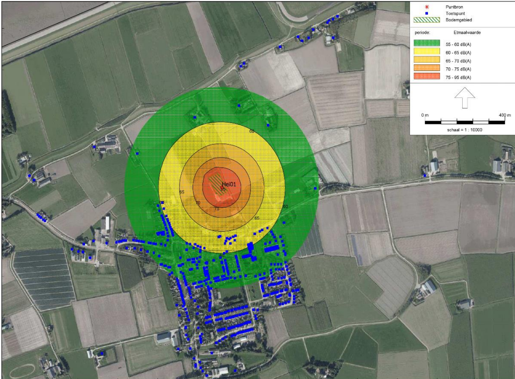
Figuur 13-10 Geluidscontouren heiwerkzaamheden in de dagperiode Locatie 1
