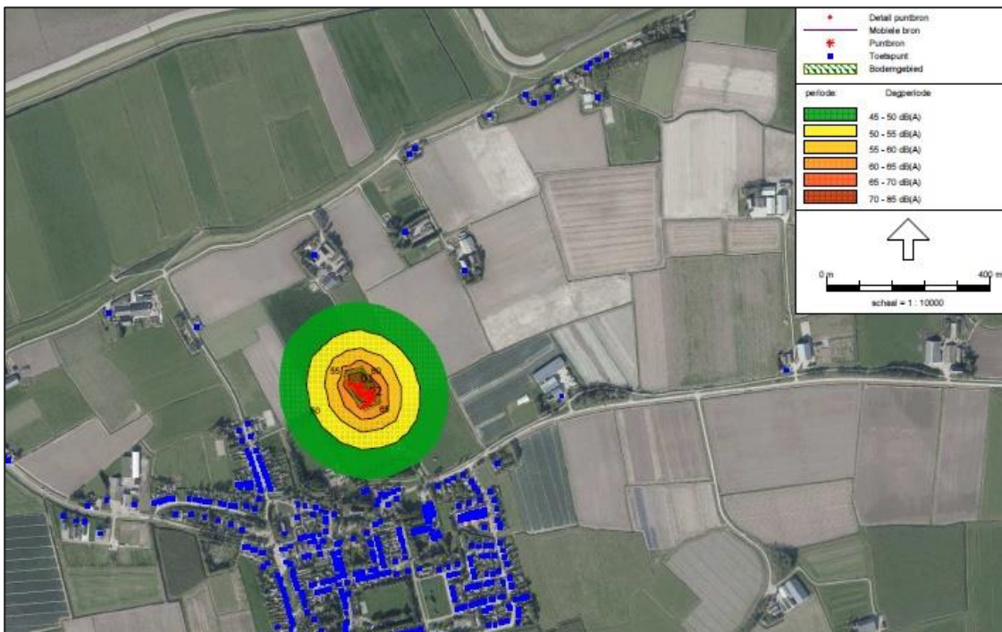
Figuur 13-36 Geluidscontouren dagwaarde verwijderingsfase Locatie 1
