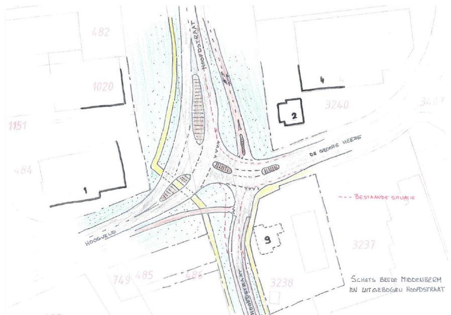
Figuur 3.2: Schets vormgevingsvariant 1: Brede middengeleider.
