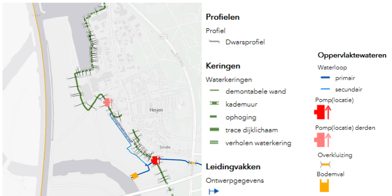
Figuur 3.5 Legger Waterschap Limburg. In groen: waterkering, lichtblauw is een secundaire waterloop, donkerblauw is primaire een waterloop.
