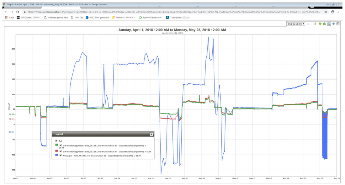
Figuur 10.2 Waterstand in de peilbuis in de omstorting en in de peilbuizen B22-1 en B22-2 op 10 m afstand tijdens alle proeven op de traditionele retourput RP3
