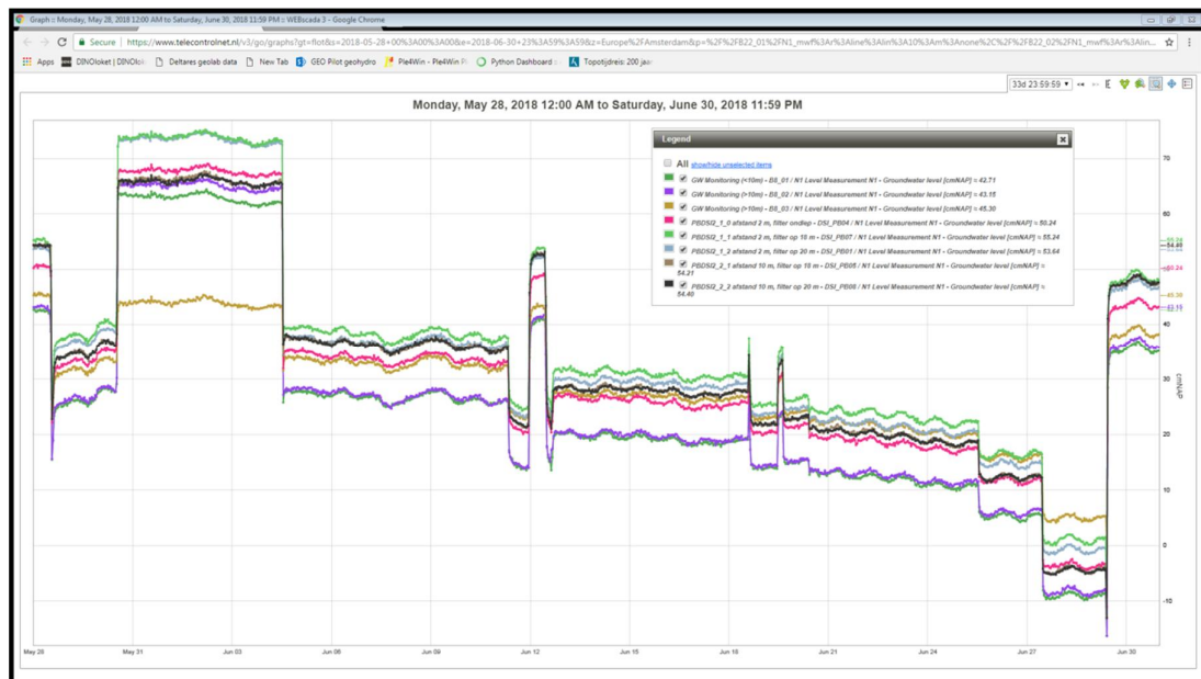
Figuur 10.5 Stijghoogteverandering bij DSI-streng 2 achter de zuivering. Retour op streng 2 was van 30 mei tot 4 juni 12:00. Effecten daarna zijn het gevolg van pompen uit PP2 en retour op DSI-streng 1 in retourveld
