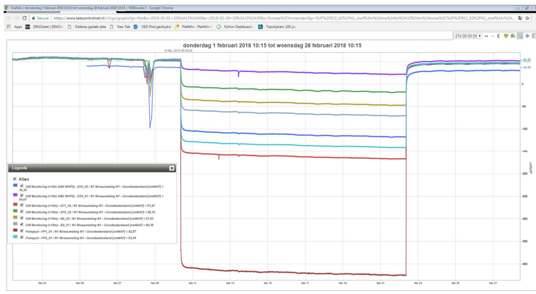
Figuur 8.1 Grondwaterverlaging in februari in de peilbuizen rond pompput PP1 bij eerste pompproef
