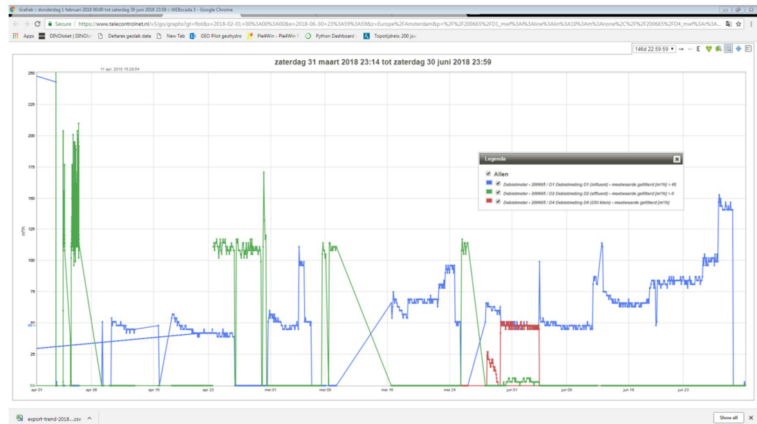
Figuur 7.5 Verpompte debieten tijdens de retourproeven. Groene lijn: watermeter voor schoonpompen. April: retourproef fase op RP3 met 50 m³/uur, Mei: retourproef fase op RP3 met pogingen om op te schalen naar 100 m³/uur, Juni: retourproef fase op DSI met opschaling naar 150 m³/u. (Schuine lijnen zijn perioden zonder data omdat de pomp uitstond)
