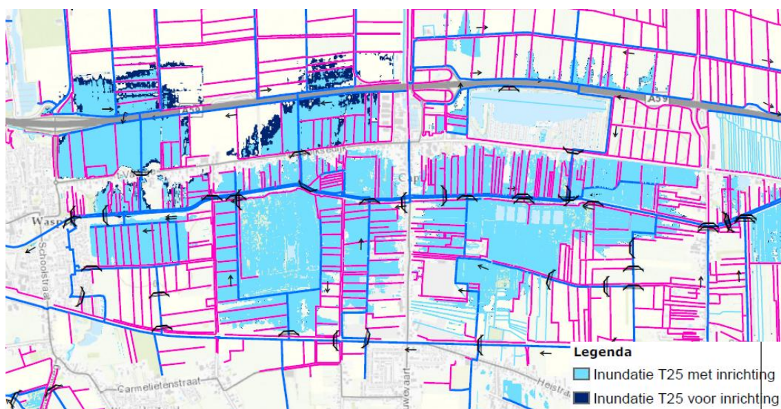
Figuur 5 Verschil in overstromingskans NBW-toetsing 2018. Donkerblauw is het oppervlak met vermindering van overstromingskans. In het overige gebied neemt de overstromingsdiepte tot 0,1 m af.
