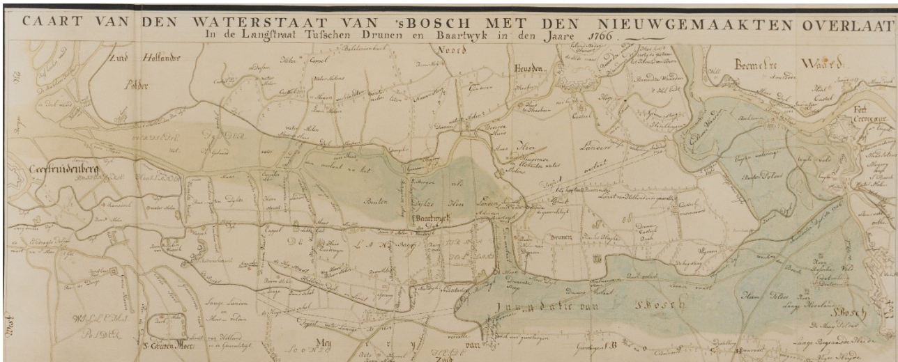
Figuur 18. Waterstaatkundige kaart van de Baardwijkse Overlaat uit 1766. In blauw/groen de stroming van het water via de overlaat aangegeven (bron: www.BHIC.nl ).
