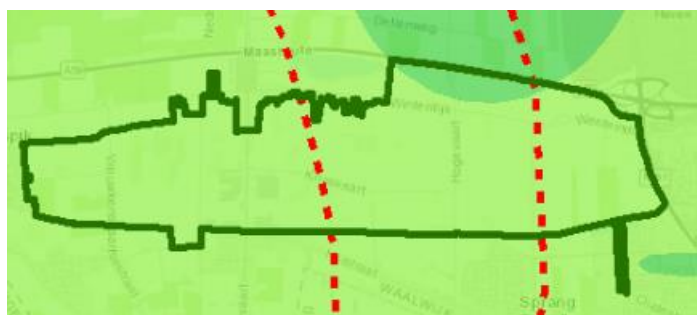
Afbeelding 7.1 Indicatie stijghoogteverandering westelijke 2e watervoerend pakket bij stopzetten grondwaterwinningen in de omgeving [lit. 8]. De rode lijnen geven geologische breuklijnen aan in de ondergrond
