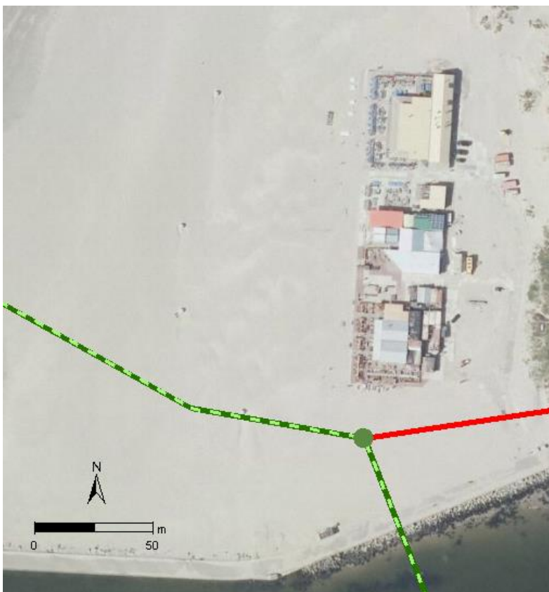
Figuur 10-37 Strandhuisjes nabij de locatie van de mofputten. De mofputten worden gebouwd in de buurt van de locatie waar de lichtgroene stip zich bevindt. Groen gestippeld zijn open ontgravingen en rood is boring.
