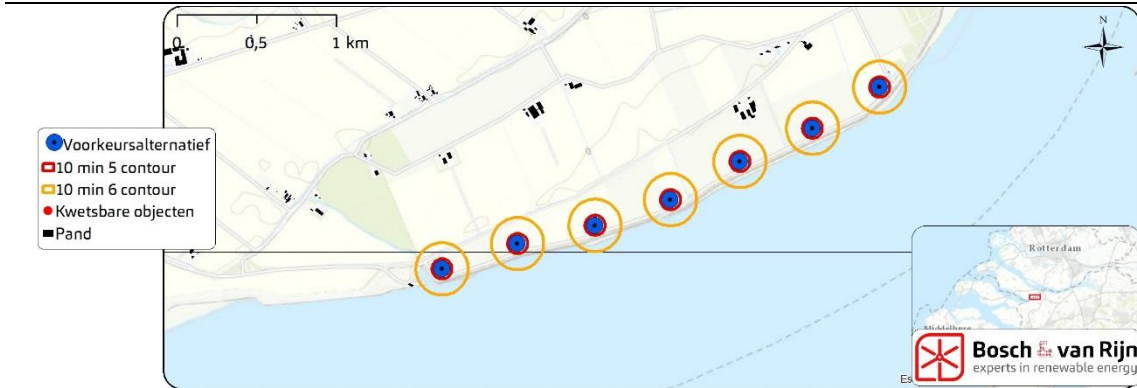
Figuur 39 Risicocontouren rond de windturbines (Bovenvariant)
