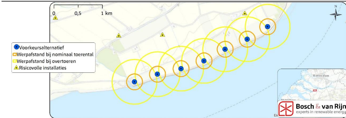
Figuur 40 Maximale werpafstand bij overtoeren van de windturbines en risicovolle installaties (bovenvariant)
