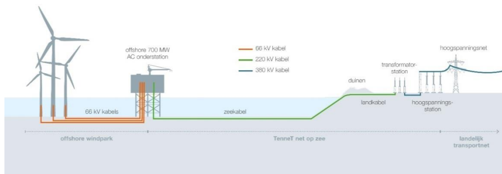
Figuur 2-2 Onderdelen net op zee
