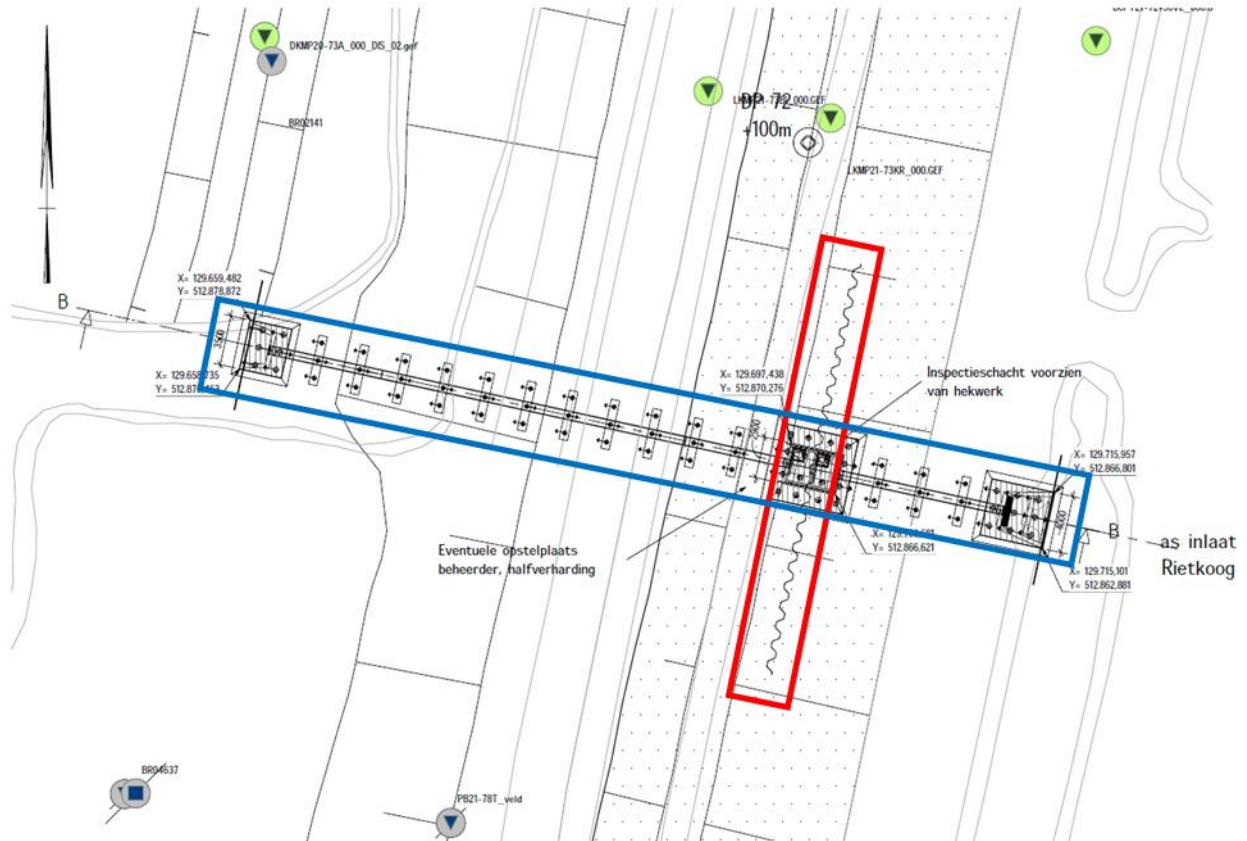
Figuur 29, Locatie Afvoer de Rietkoog, damwand (rode omkadering) en paalfundering (blauwe omkadering)
