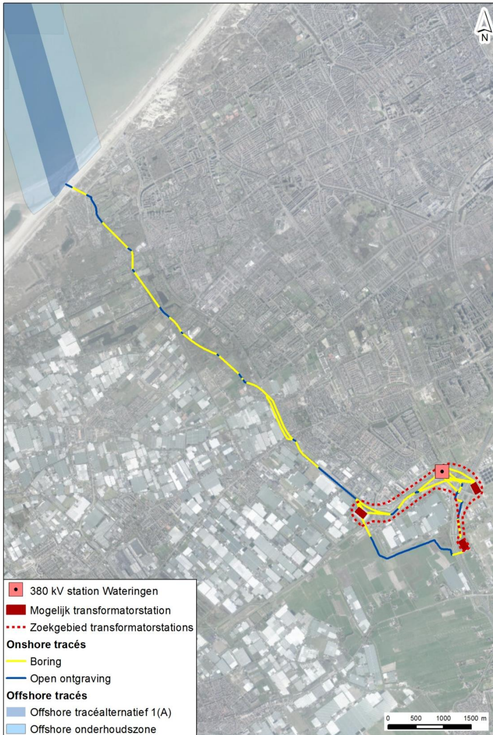
Afbeelding 4.15 Aanlegmethoden (open ontgraving/gestuurde boring) tracéalternatief 1(A)
