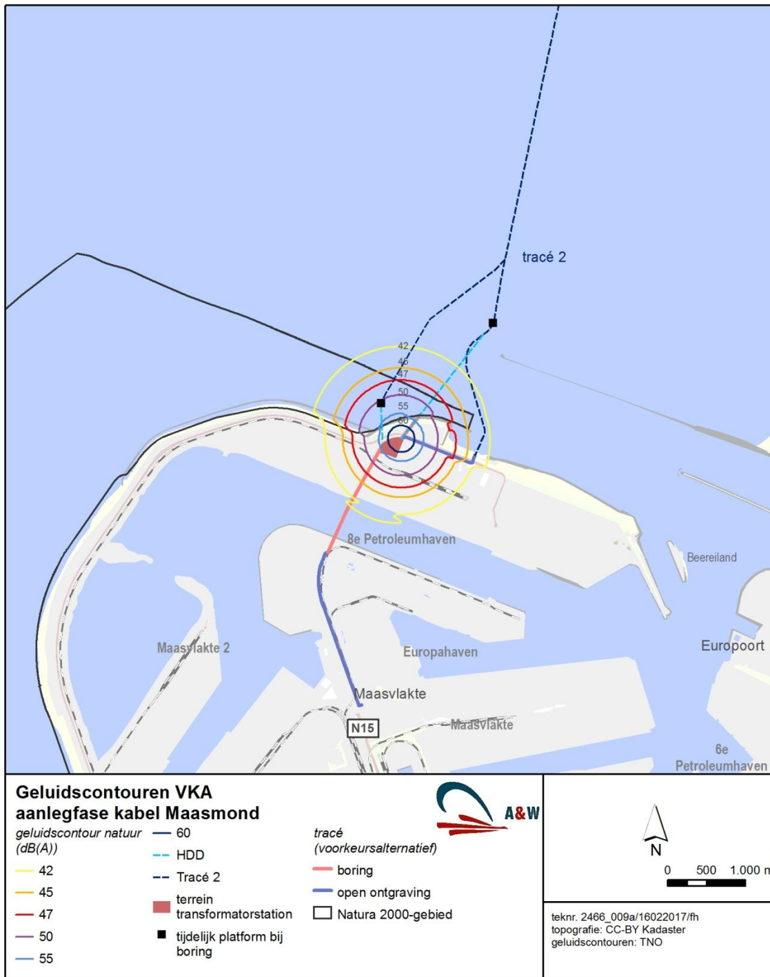
Afbeelding 6.4a Aanlegfase: Geluidscontouren van de HDD boring vanaf het terrein van het transformatorstation (variant 2 en 3)
