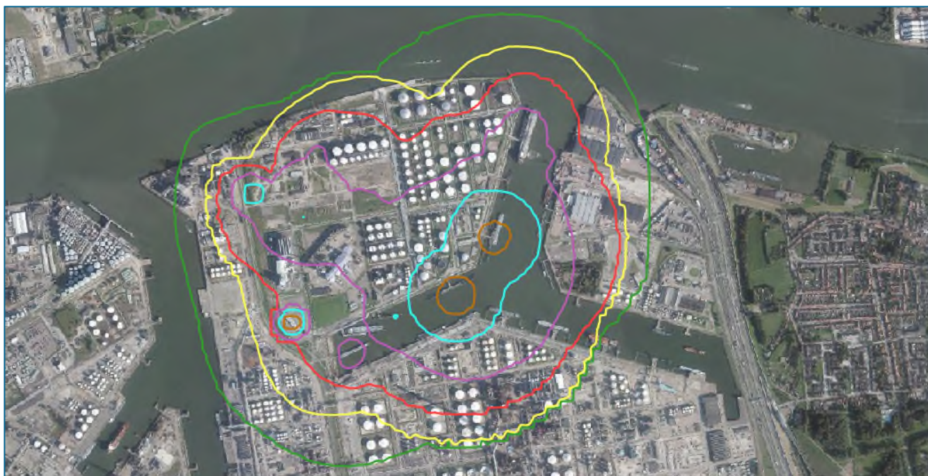
Figuur 7.1: Het berekende plaatsgebonden risico voor KTM (bruin: 10^{-3} /jaar, blauw: 10^{-4} /jaar, paars = 10^{-5} /jaar, rood = 10^{-6} /jaar, geel = 10^{-7} /jaar, groen = 10^{-8} /jaar).
