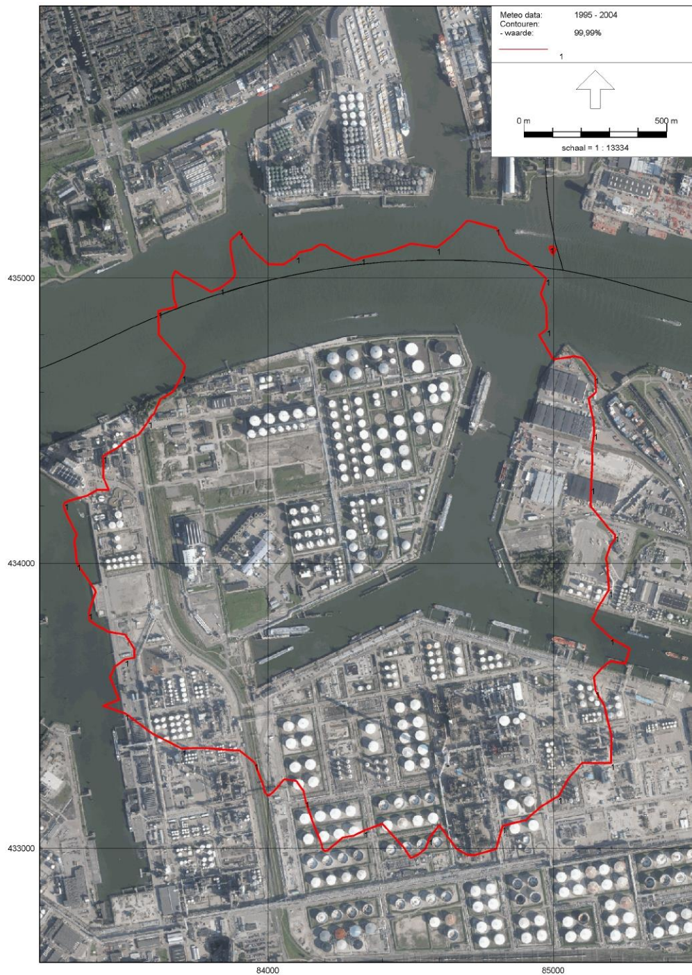
Figuur e Geurcontour van 1 \text{ ou}_E/\text{m}^3 als 99,99-percentielwaarde als gevolg van Koole Tankstorage Minerals B.V. te Rotterdam in de tussensituatie
