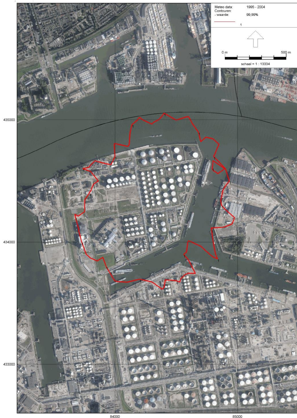
Figuur f Geurcontour van 1 \text{ ou}_E/\text{m}^3 als 99,99-percentielwaarde als gevolg van Koole Tankstorage Minerals B.V. te Rotterdam in de aangevraagde situatie
