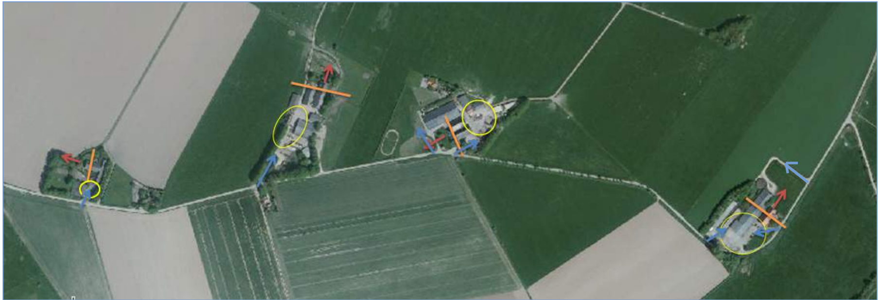
Agrarische erven in de Havikerwaard: rood geeft de oriëntatie van het voorhuis aan. Oranje is de lijn tussen het voorhuis en het achterhuis. Geel het centrale werkerf en blauw geeft de ontsluiting van het erf aan.
