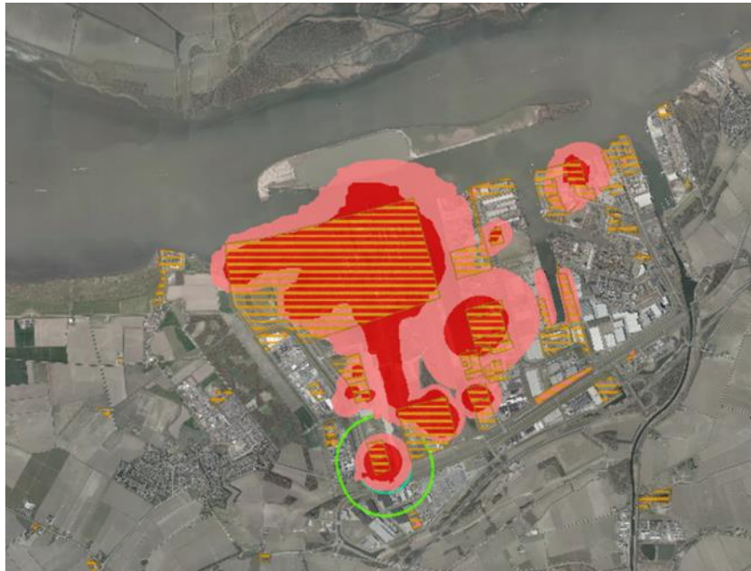
figuur 6.1 Ligging risicobronnen op en nabij ZIM (oranje arcering) en de risicocontouren 10^{-5} (rood) en 10^{-6} (roze). De groene cirkel is de C-cirkel gerelateerd aan de opslag van explosieven (zie paragraaf 6.2.5)
