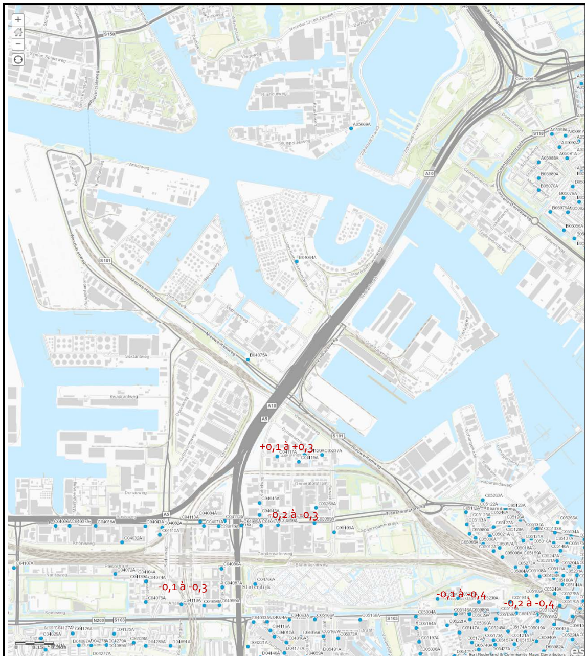
Figuur 2 Freatische peilbuizen Waternet (Bron 14), met in rood een indicatie van de gemeten gemiddelde grondwaterstanden in freatisch pakket (m NAP)
