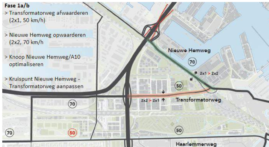
figuur 5-5 Afwaardering Transformatorweg en opwaardering Nieuwe Hemweg
