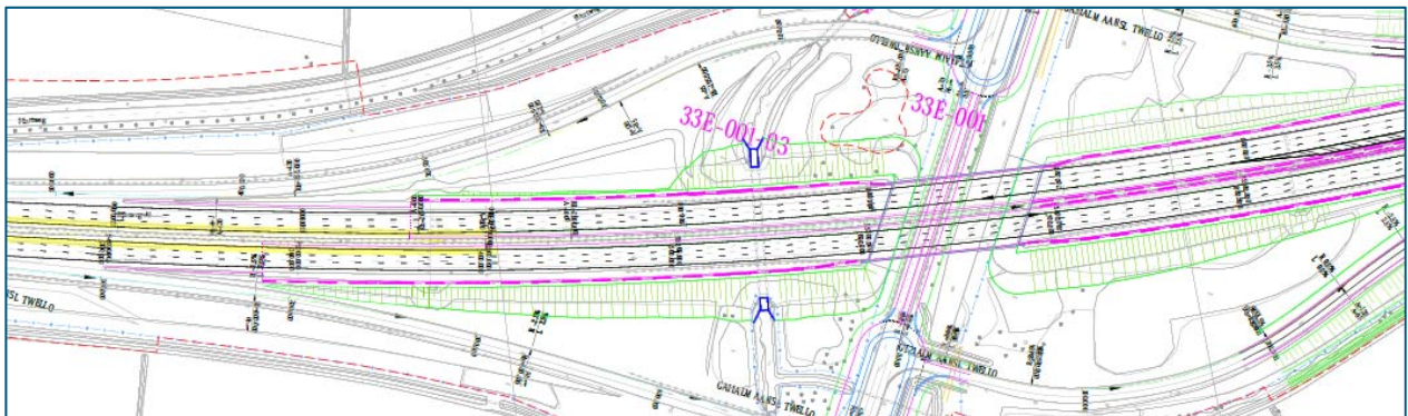
Figuur 16 Fase 1 Twello: overgang 2x3 rijstroken naar 2x2+spitsstrook (Gele arcering = spitsstrook)
