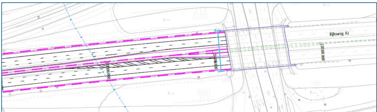
Figuur 17 Fase 1 Rijssen: overgang 2x3 rijstroken naar 2x2 rijstroken
