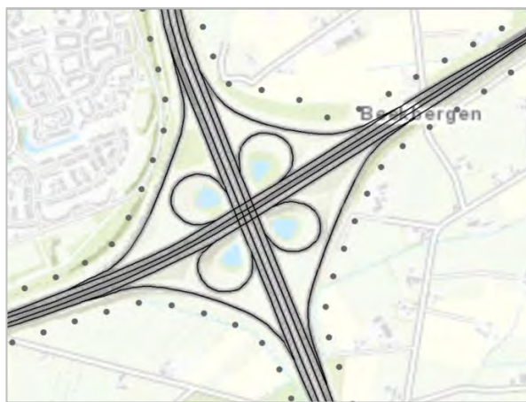
Afbeelding 1-2 Schematische weergave referentiepunten bij een knooppunt.
