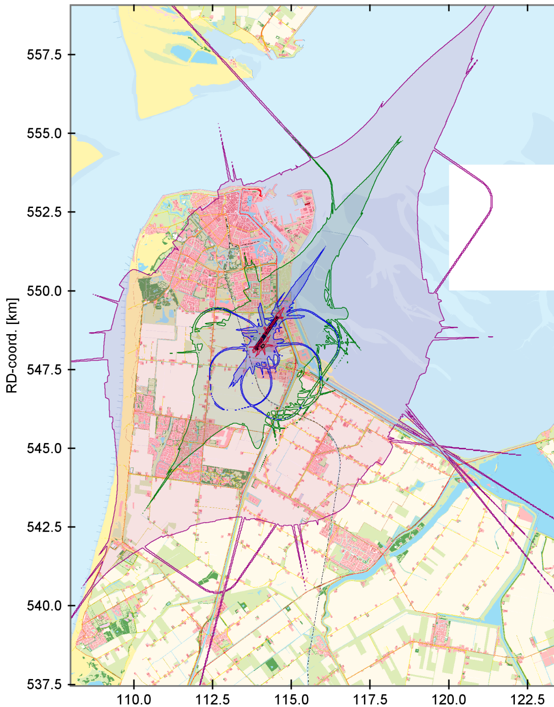
Figuur 4-1: Plaatsgebonden risicocontouren van de Referentiesituatie. Gepresenteerd zijn de contouren met meteotoeslag voor de risicowaarden 5 \cdot 10^{-5} (zwart), 1 \cdot 10^{-5} (rood), 1 \cdot 10^{-6} (blauw) en 1 \cdot 10^{-7} (groen) en 1 \cdot 10^{-8} (paars) per jaar
