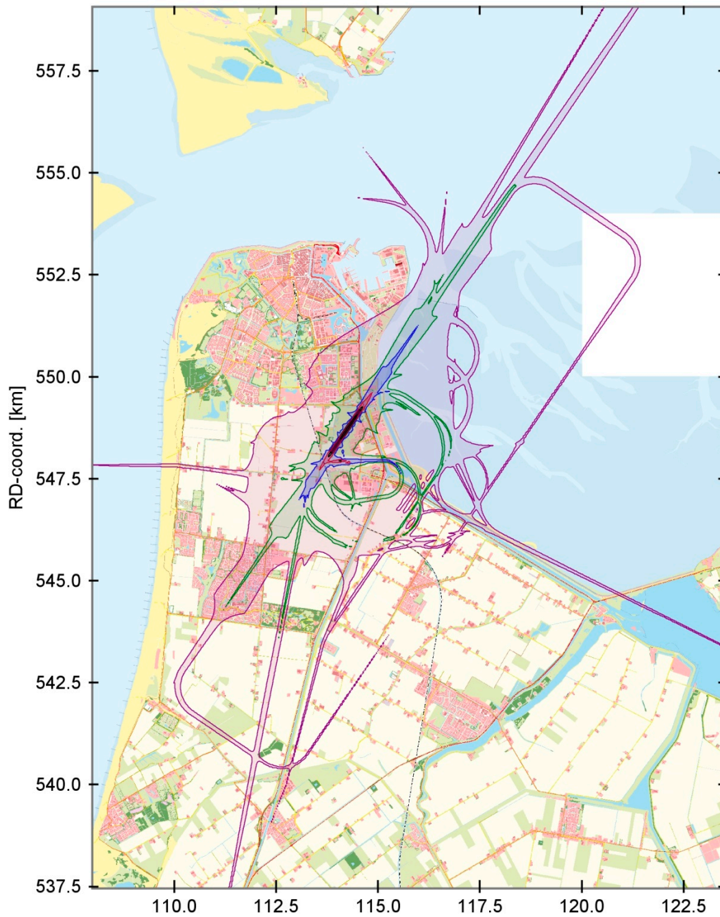
Figuur 4-3: Plaatsgebonden risicocontouren van het NH-90 alternatief. Gepresenteerd zijn de contouren met meteotoeslag voor de risicowaarden 5 \cdot 10^{-5} (zwart), 1 \cdot 10^{-5} (rood), 1 \cdot 10^{-6} (blauw) en 1 \cdot 10^{-7} (groen) en 1 \cdot 10^{-8} (paars) per jaar
