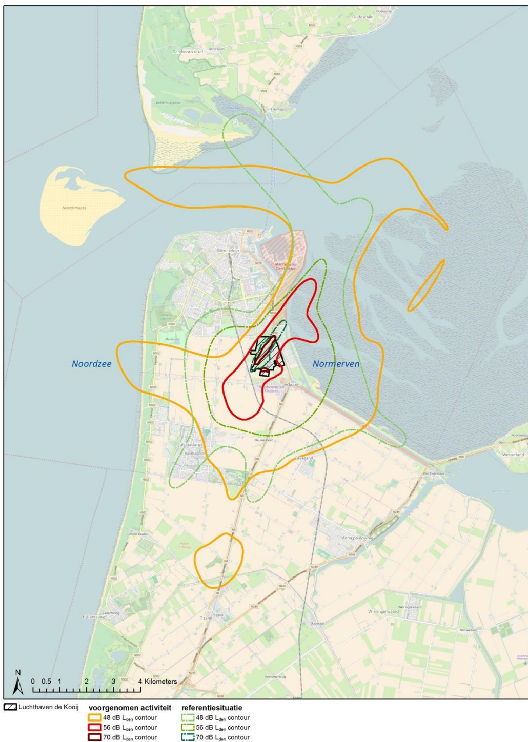
Figuur 5.5: Ligging van 48, 55 en 70 dB Lden contouren van voorgenomen activiteit en referentie MER
