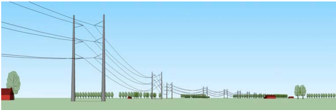
Figuur 18 hoogspanningsverbinding met richtingsverandering van 20 graden
