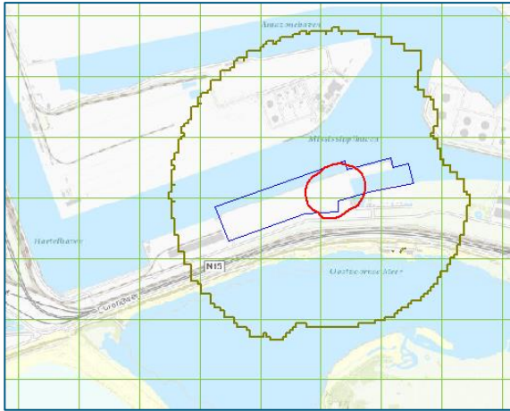
Figuur B3.7: PR één opslagtank (25.000 m3) in tankput TP07
