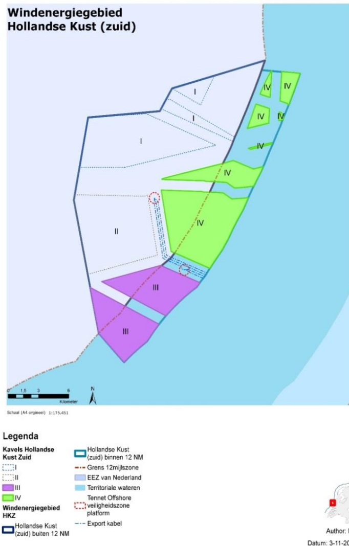
Figuur 3 Schematische verkaveling van windenergiegebied Hollandse Kust (zuid)
