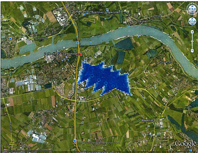
Figuur 4.7: Slagschaduw contour in Zaltbommel, locatie A2
