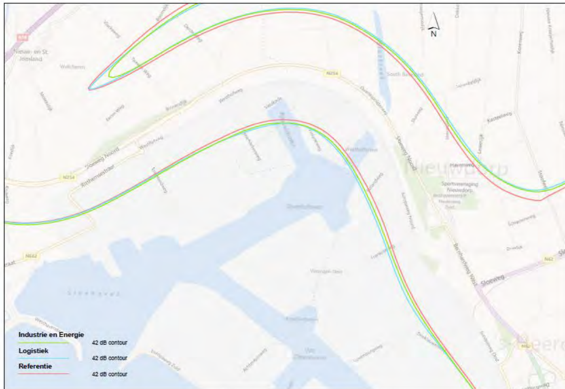
Afbeelding 26: Geluidscontour Alternatief Industrie en Energie en Alternatief Logistiek als gevolg van verkeer en vervoer
