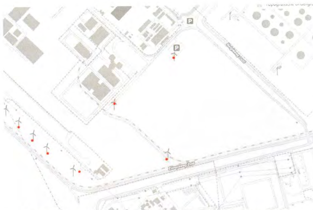
Figuur 1.2. Windturbines in het plangebied, ashoogte 78m rotordiameter 82m, tiphoogte 119m
