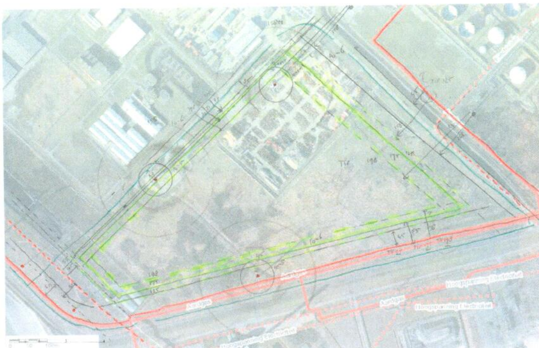
Figuur 2.5. Zonering in het plangebied op grond van de veiligheidscontour 10^{-5} en 10^{-6} van windturbines met een tiphoogte van 125, 175 en 198 meter.
