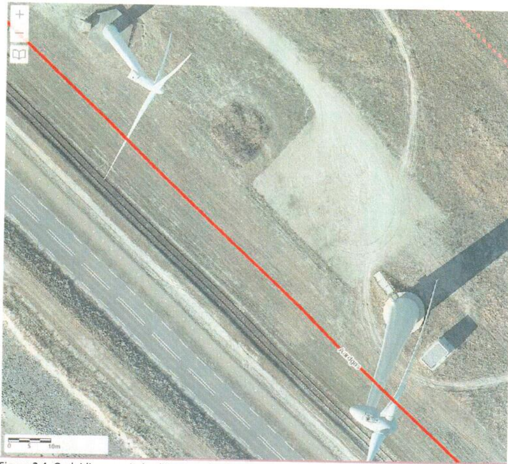
Figuur 2.4. Gasleiding en windturbines van de Sloelijn op korte afstand (15m) van de gasleiding (van de gasgestookte centrale). Bron Geoweb Zeeland, luchtfoto 2015.
