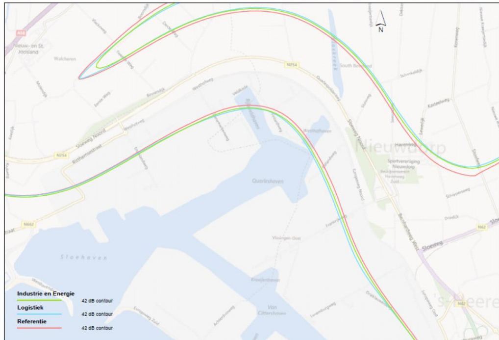
Afbeelding 3: Visualisatie van de 42 dB(A) contour om de toename van geluid door wegverkeer te illustreren.
