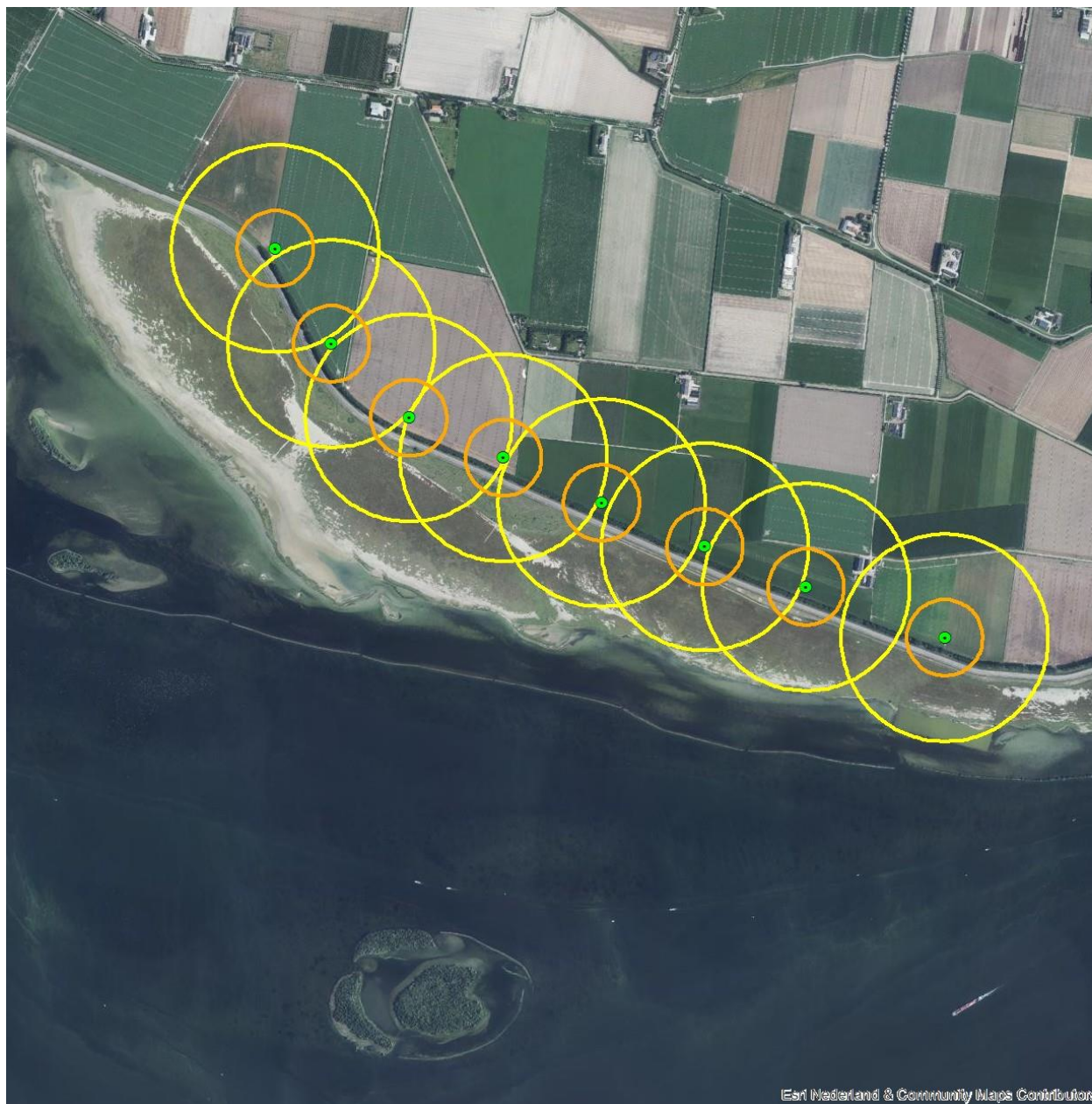
Figuur 18 – Werpafstand bij nominaal toerental en overtoeren Ondergrens
