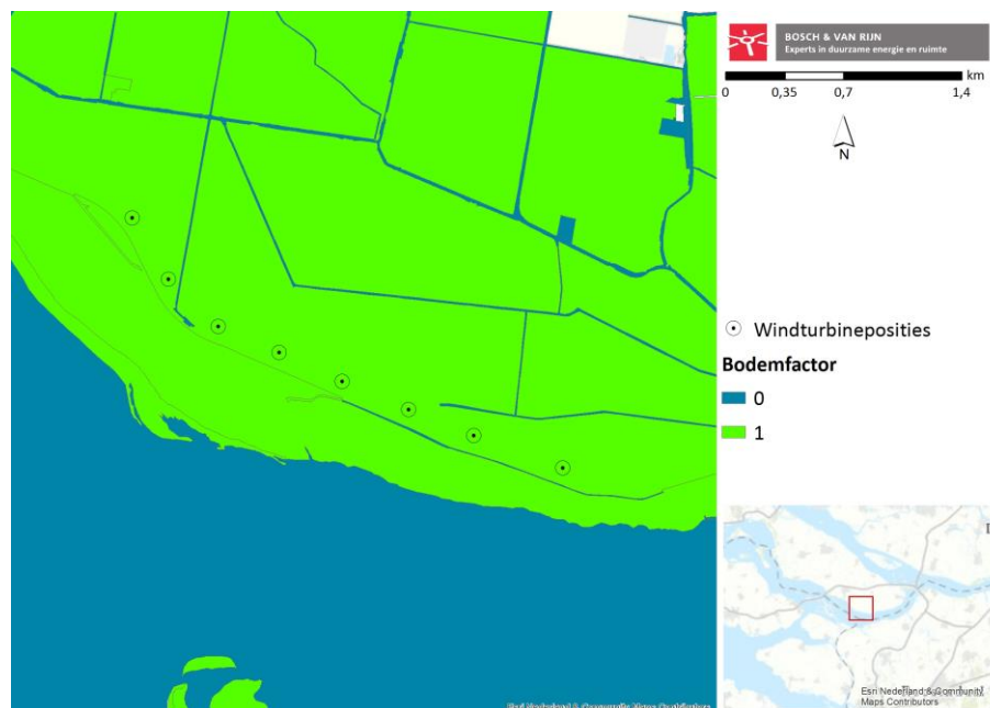
Figuur 2 - Bodemabsorptie en -reflectie rondom het windpark.
