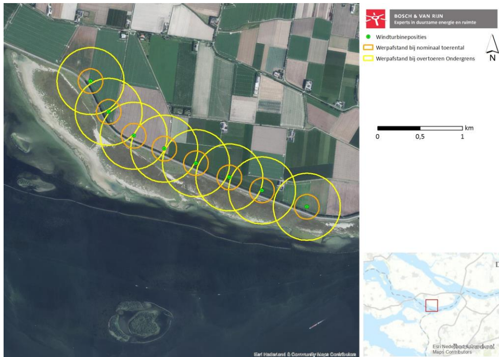
Figuur 12 – Maximale werpafstand bij nominaal toerental en overtoeren van de windturbines en hoogspanningsleidingen.
