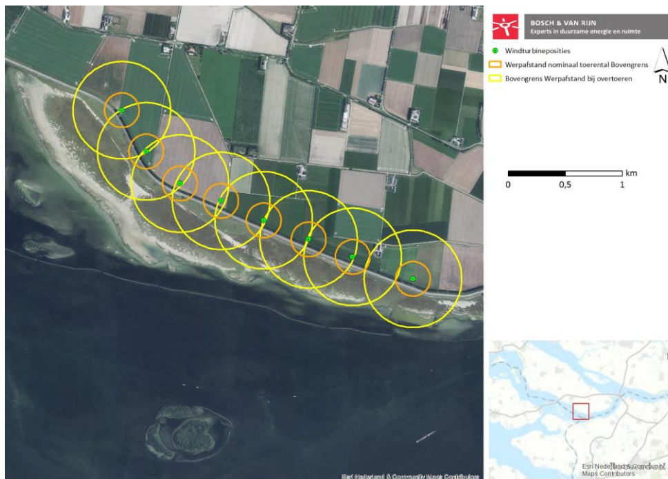
Figuur 9 – maximale werpafstand bij nominaal toerental en overtoeren van de windturbines en buisleidingen Bovengrens.
