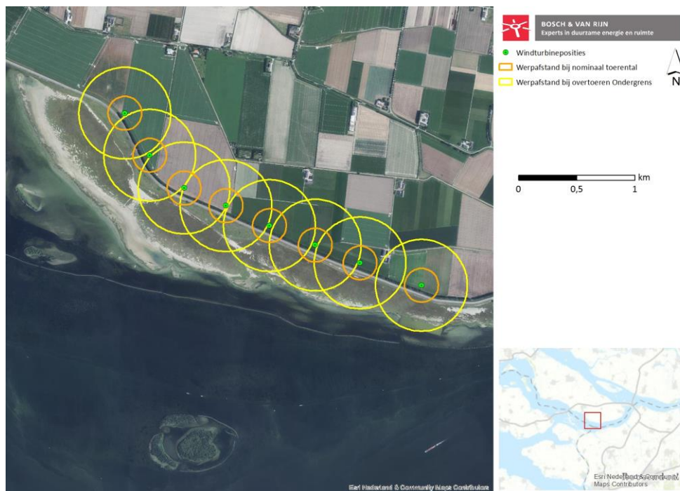
Figuur 10 – Maximale werpafstanden bij nominaal toerental en onvertieren van de windturbines en buisleidingen Ondergrens.
