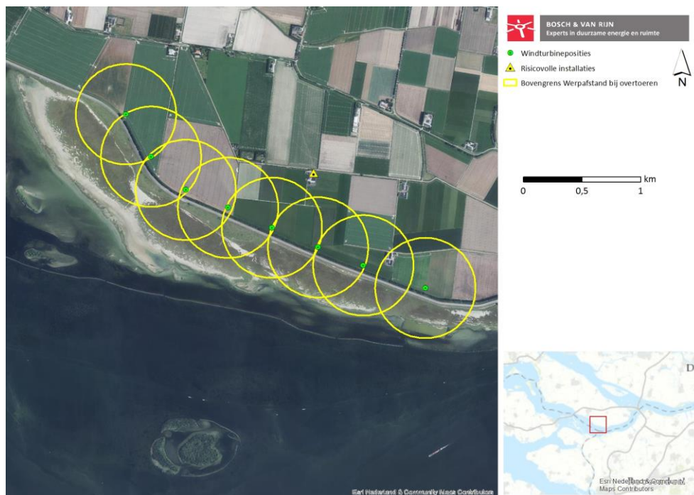
Figuur 39 - Maximale werpafstand bij overtoeren van de windturbines en risicovolle installaties (bovengrens)
