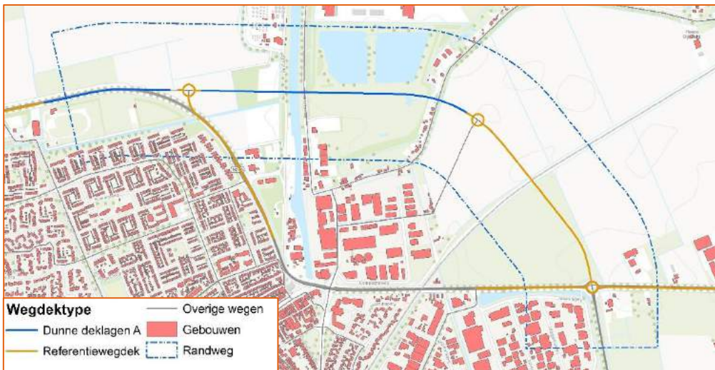
Figuur 15: Doelmatige maatregelen (Dunne dekklagen A)
