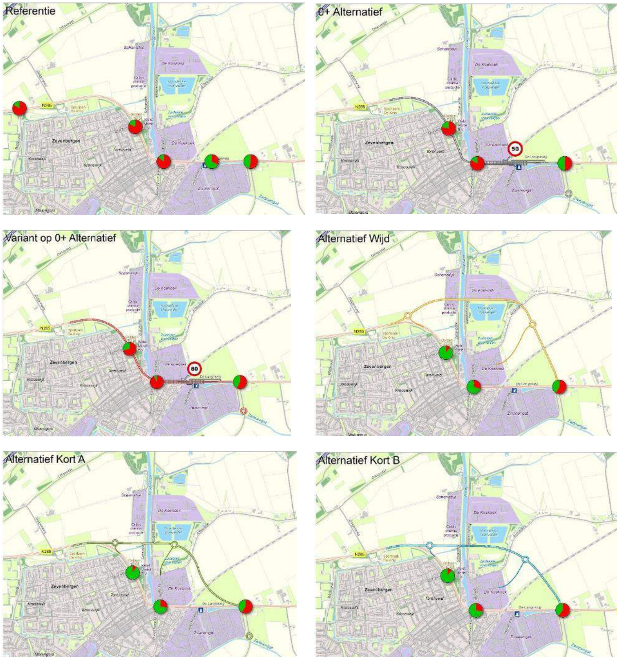
Afbeelding 8-13: Kruispuntbelasting 2030 per alternatief in de avondspits voor de kruispunten N285 met de Schansdijk, Prins Hendrikstraat en Oostrand. In de referentiesituatie zijn ook de kruispunten met de Westrand en Industrieweg opgenomen.
