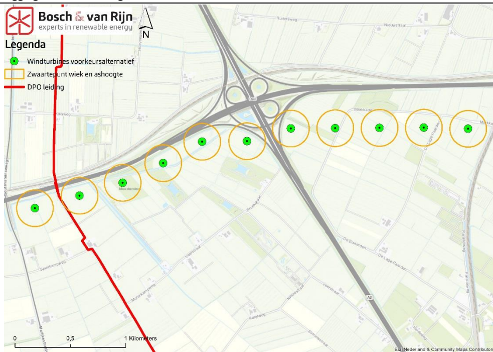
Figuur 11 Ligging brandstofleiding t.o.v. de windturbines.
