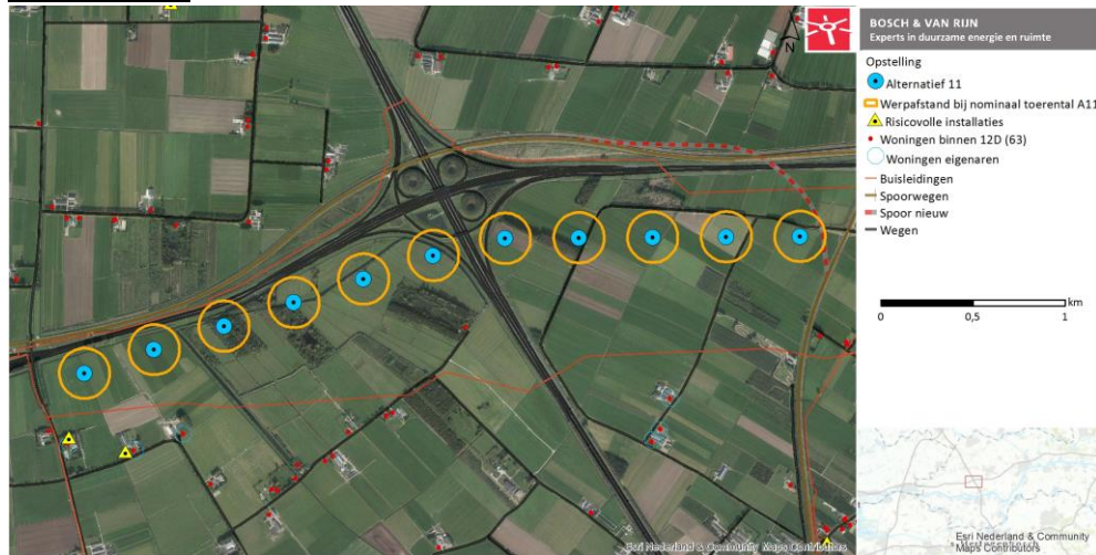
Figuur 17 – Werpafstand bij nominaal toerental en buisleidingen alternatief 11
