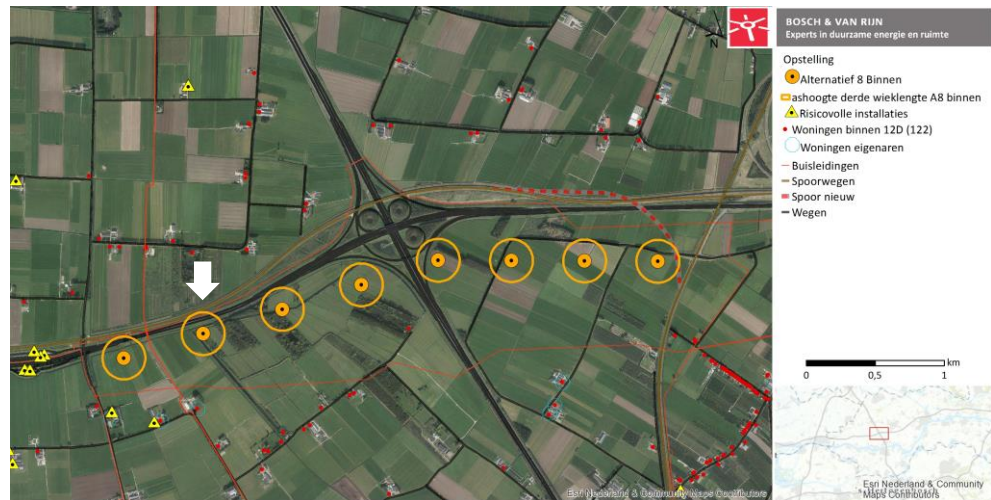
Figuur 37 – Afstand ashoogte + afstand zwaartepunt wiek en buisleidingen (8 binnen)
