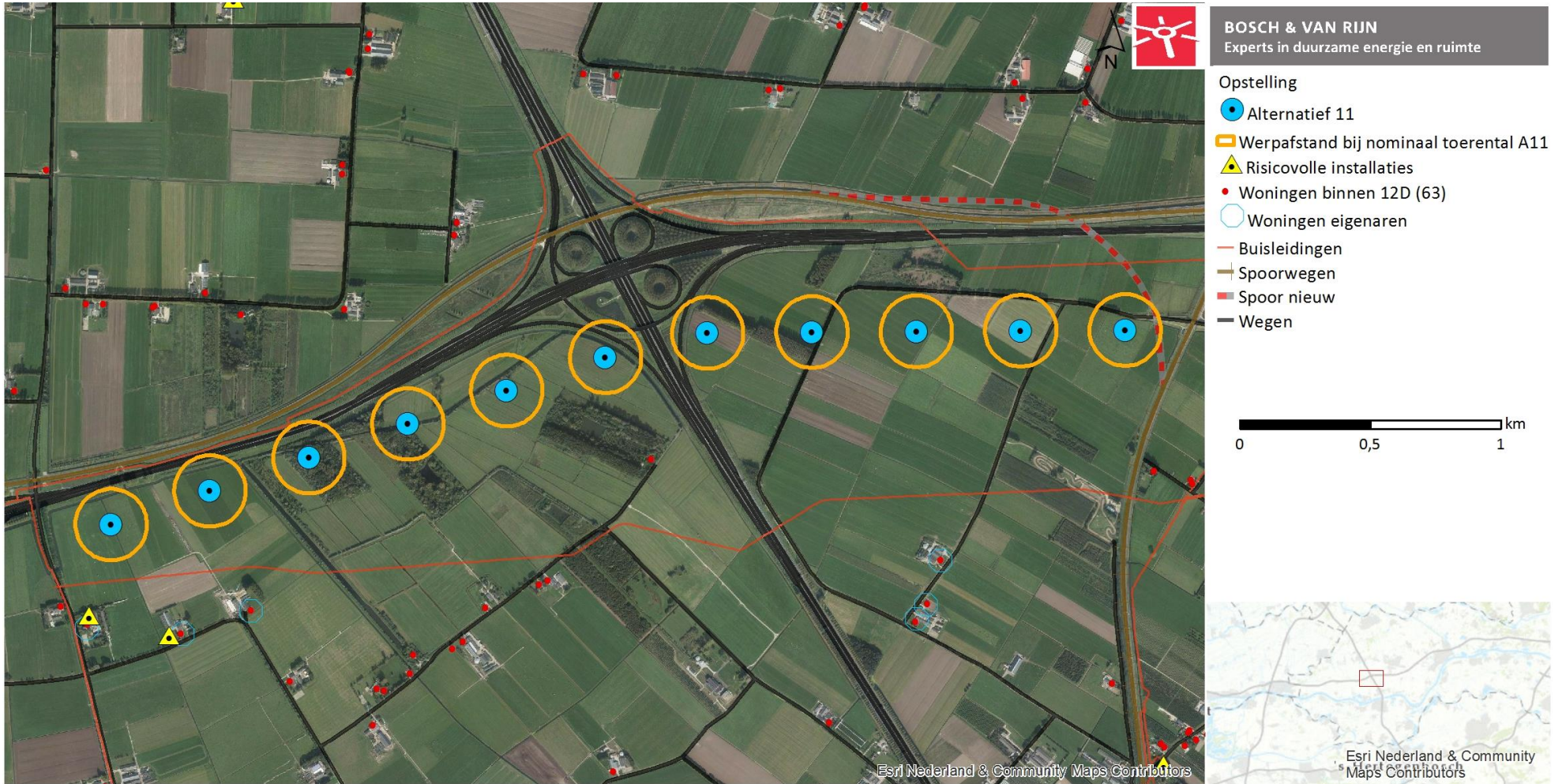
Figuur 47 – Werpafstand bij nominaal toerental Alternatief 11
