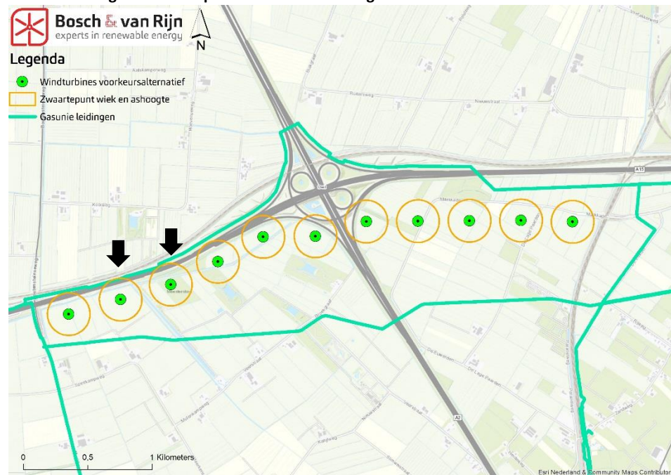
Figuur 4 Afstand ashoogte + zwaartepunt wiel en buisleidingen VKA
