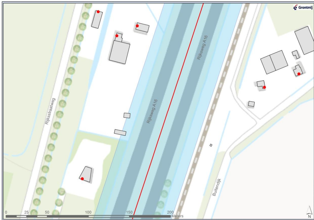
Figuur 4.10 Ligging van twee objecten (showmodel blokhutten) binnen de basisnetafstand van de A16 (wegvak Z58) ter hoogte van Rijksstraatweg 138 te Dordrecht. Van noord naar zuid zijn de standen tot het referentiepunt: 41,3 m respectievelijk 39,8 m (gebaseerd op de afstanden uit Tabel 3.12)
