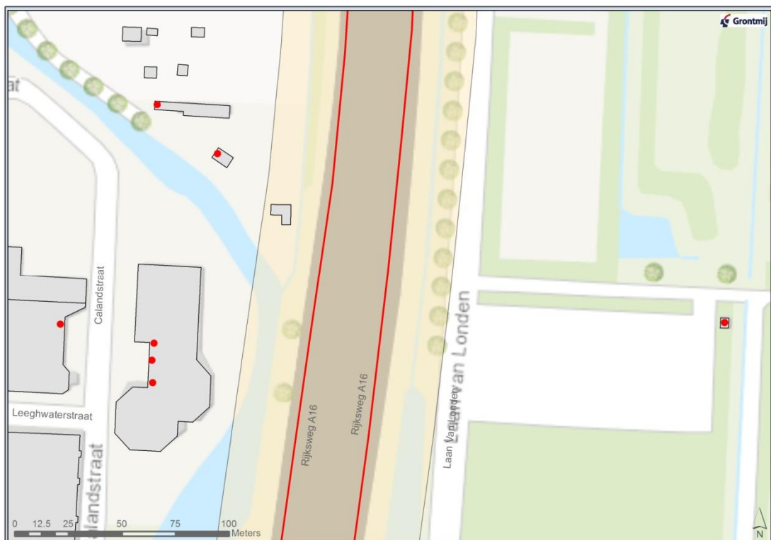
Figuur 4.14 De ligging van een schuur binnen het PAG (beige zone, 30 meter) van de A16 (wegvak Z57) met een afstand van 16,5 m vanaf het PAG meetpunt (rode lijn)
